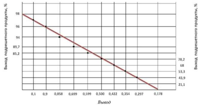
Выход, состава продукта проходящий через сито от 2,5 до 0,6 мкм составляют примерно 2-12%. Выход состава продукта проходящего через сито от 0,4 до 0,1 мм составляет примерно 17-49,3%...Самая мелькая фракция — 0,05 мкм составляет 7,5%.
