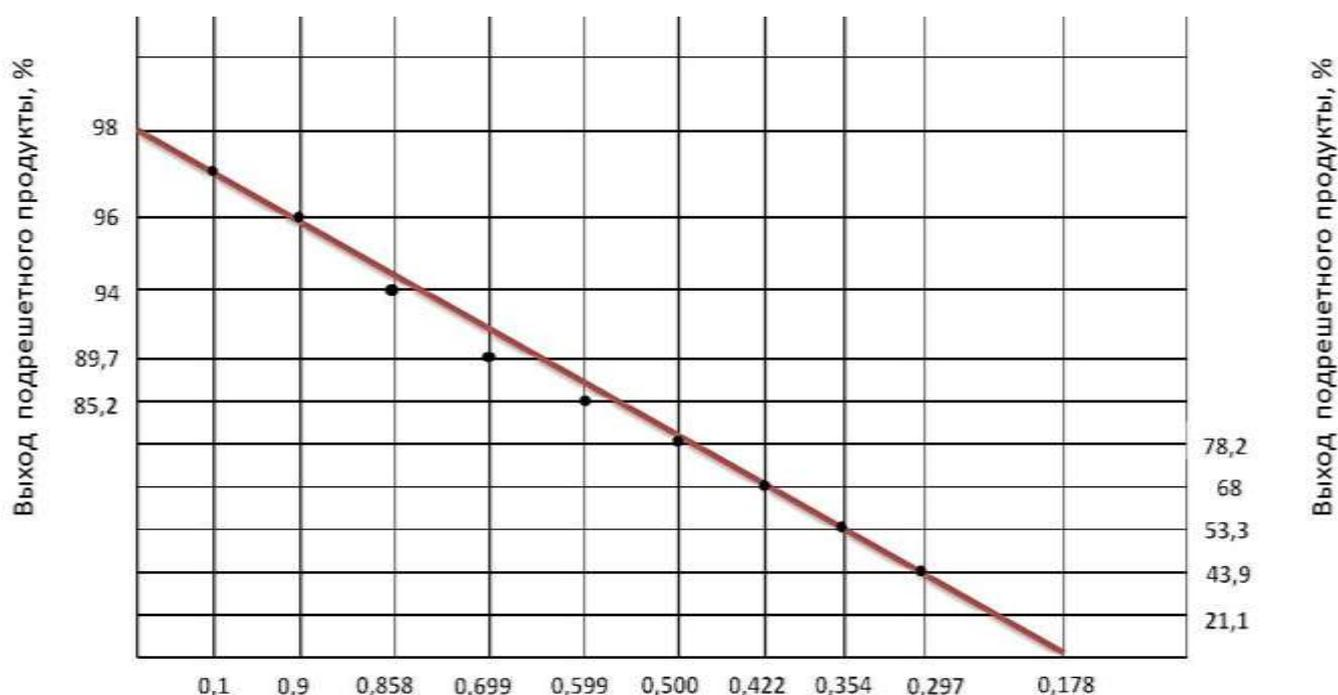
Рисунок 2. Кривая гранулометрического состава в логарифмической системе координат
