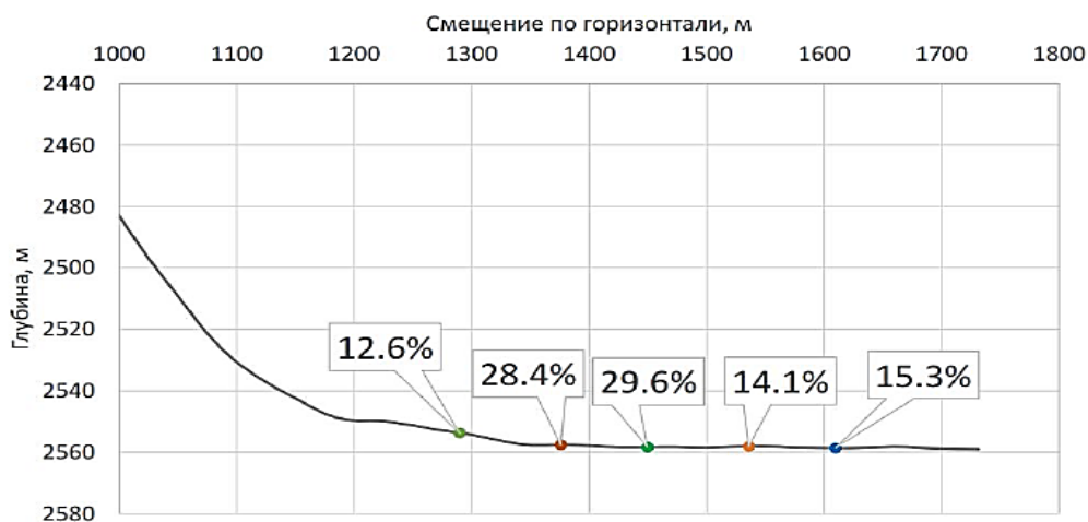
Рисунок 4. Распределение притока жидкости по зонам скважины №4Г (замер от 18.11.2015)
