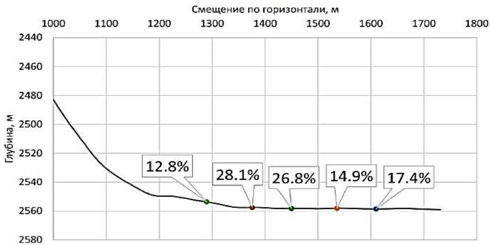
Рисунок 3. Распределение накопленного притока жидкости по зонам скважины №4Г (период 11.05.2015-18.11.2015)
