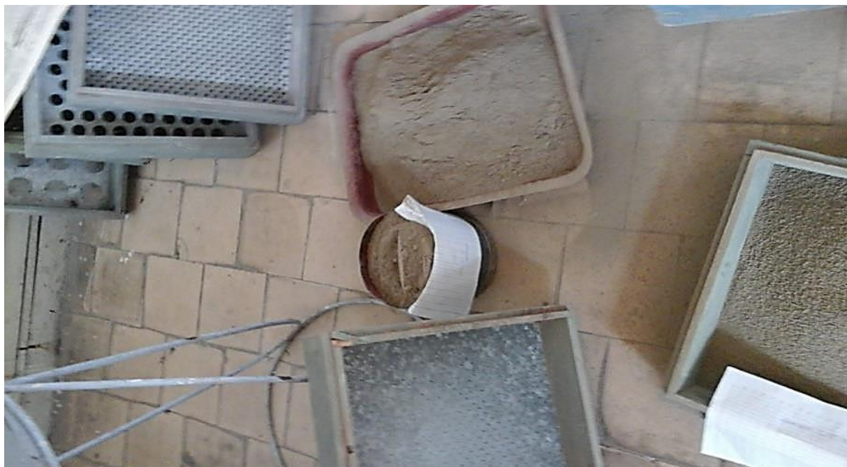
Рисунок 3. Пропускание через сито базальтового порошка
