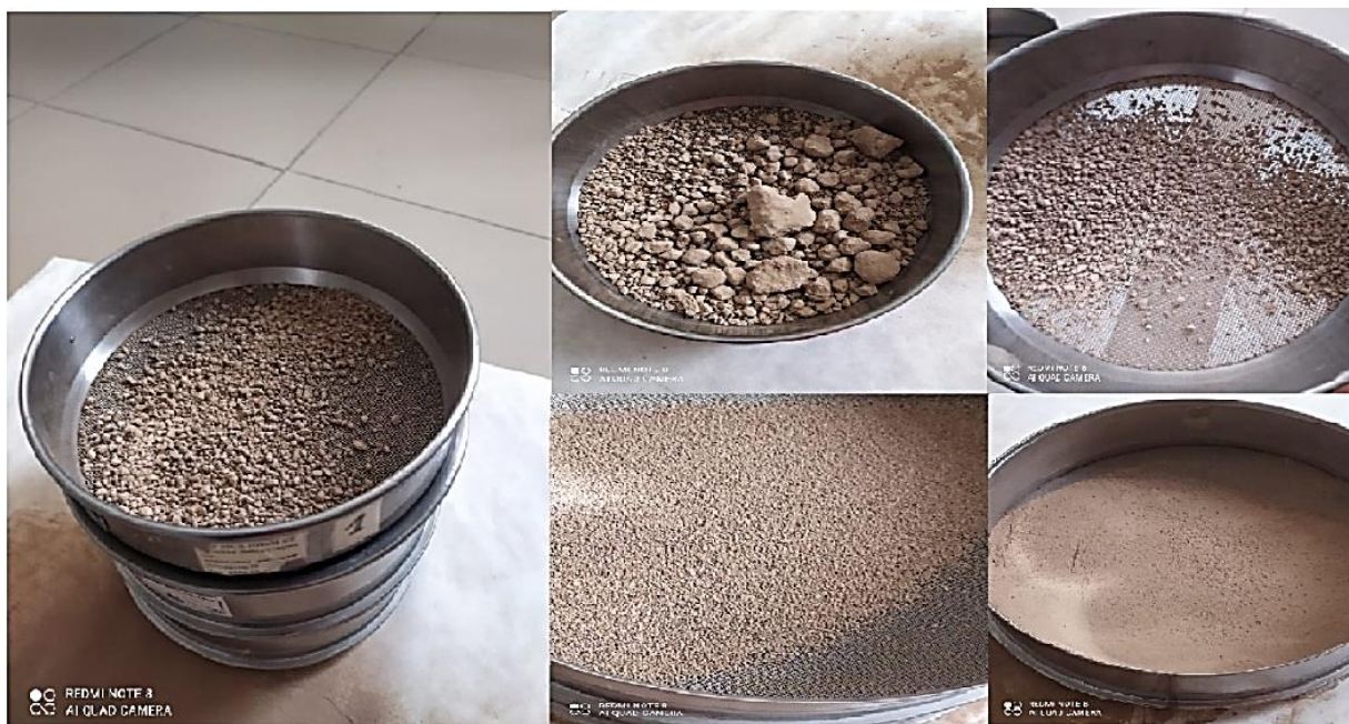
Рисунок 2. Пропускание суглинка через сито
