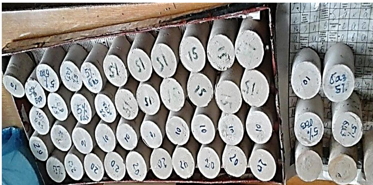
Рисунок 4. Образцы после сушки в сушильном шкафу
