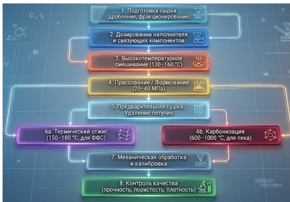
Рисунок 1. Двухветвевая (термическая вставка / карбонизация) технологическая блок-схема в зависимости от типа связующего
