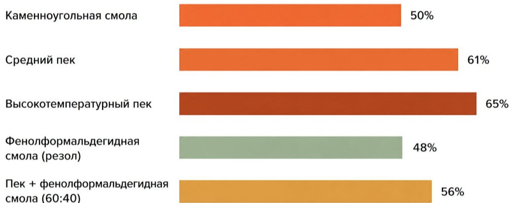
Рисунок 4. Диаграмма эффективности коксования (эффективности карбонизации) при 900 °C для различных типов вяжущих материалов
