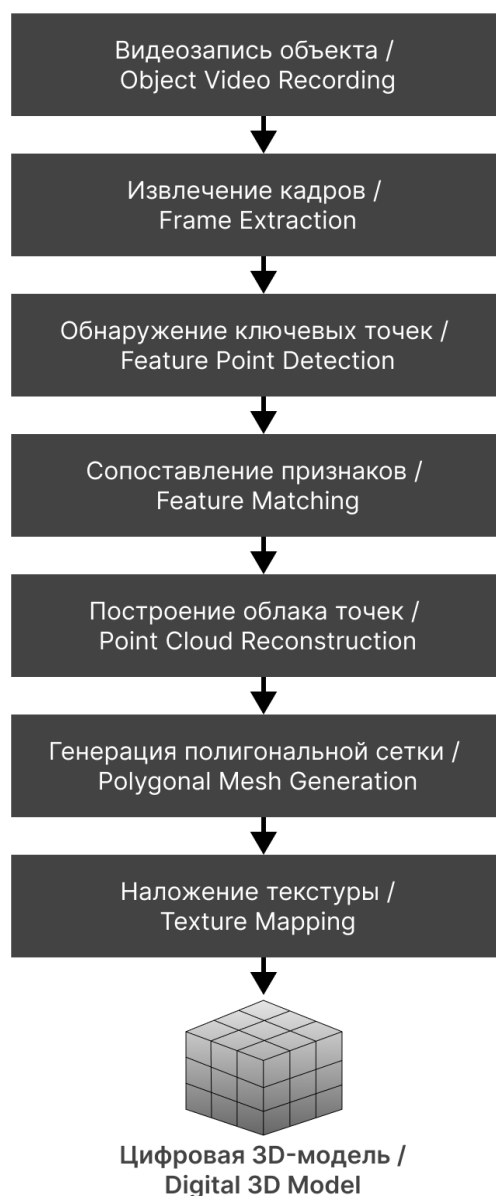
Рисунок. Схема процесса преобразования видеоизображений в 3D-модель
