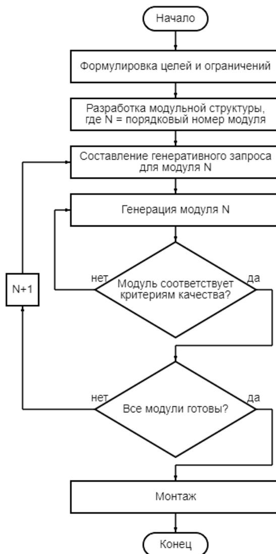
Рисунок 1. Блок-схема итерационной методики
