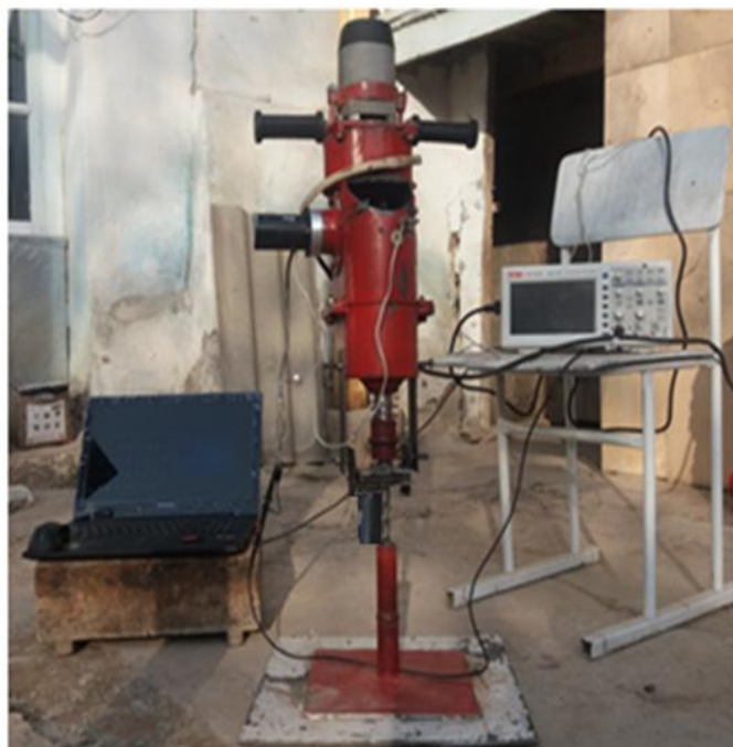
Рисунок 2. Экспериментальный стенд для исследования динамики электромеханического перфоратора
