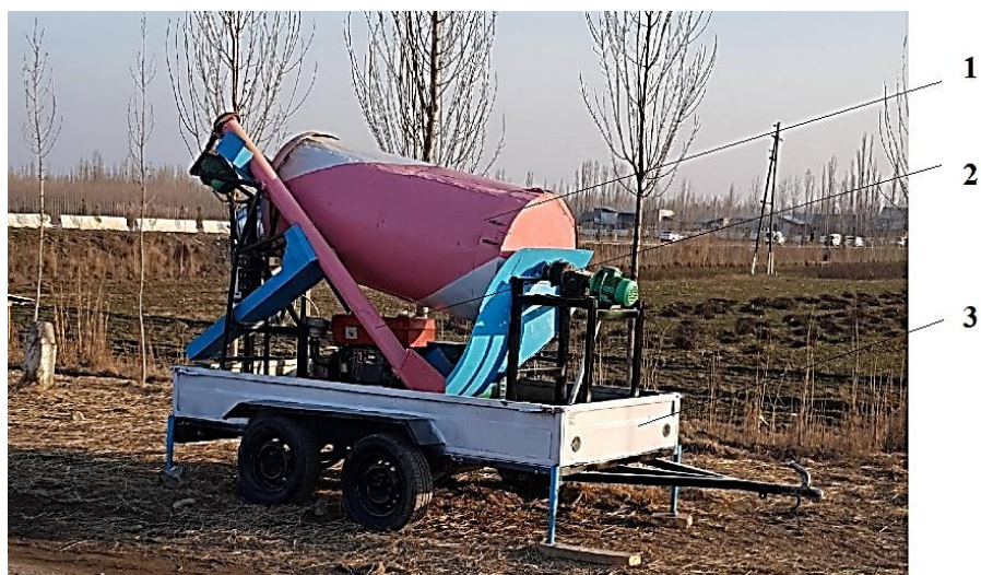
Рисунок 1. Мобильная сушилка для шала: 1 — сушильный барабан; 2 — винтовой конвейер; 3 — автоприцеп
