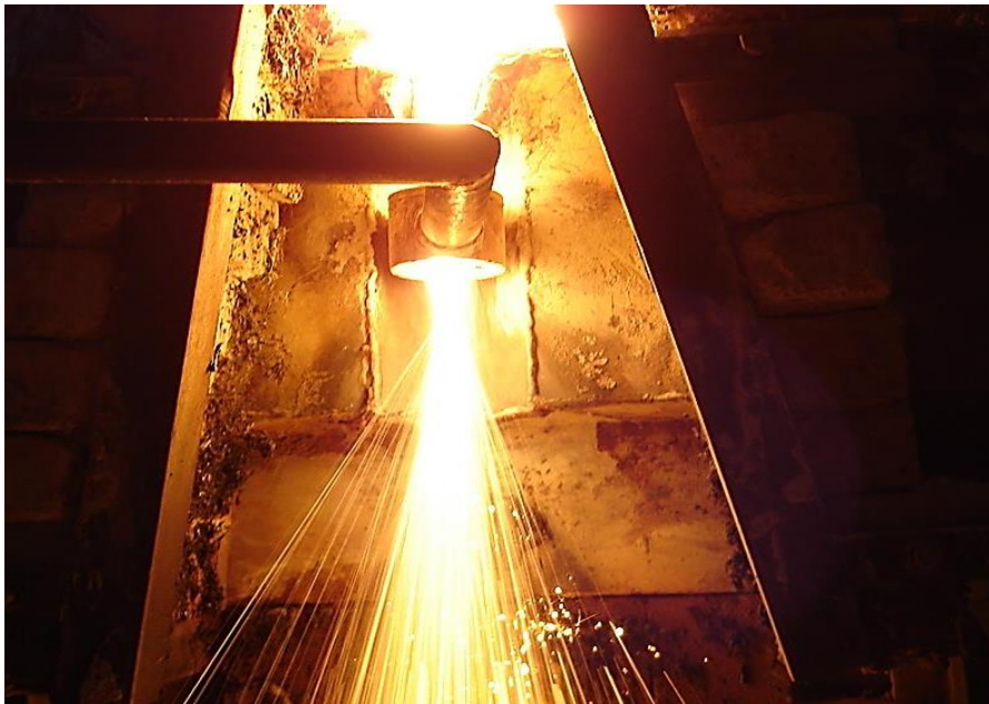
Рисунок 2. Расщепление базальтового расплава в волокно.
