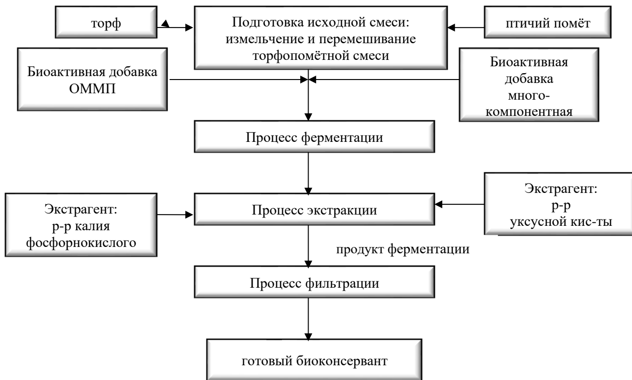
Рисунок 1. Схема получения биоконсерванта с использованием разных стимуляторов и экстрагентов: по базовой технологии ф слева, по новой — справа.
