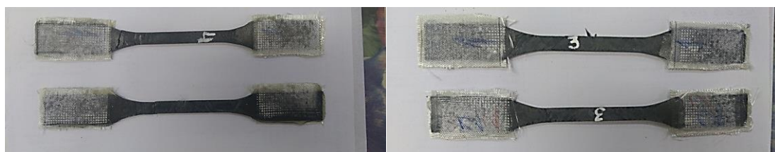
Рисунок 2. Образцы-лопатки для определения прочности при растяжении (после испытаний).
