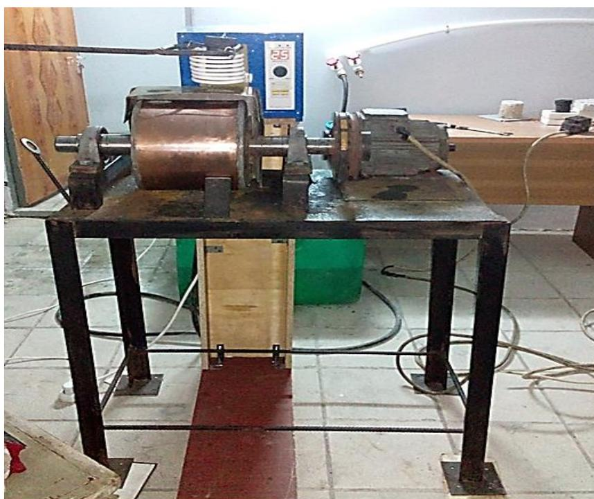
Рисунок 1. Установка для получения лент с аморфной структурой.
