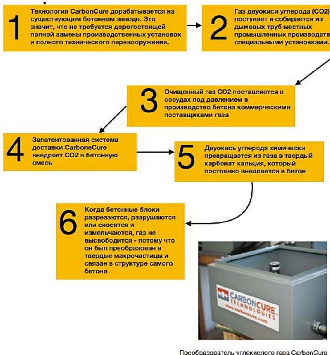
Рисунок 1. Схема «Технология производства бетона при помощи технологии CarbonCure» (<https://goo.gl/a3YSJC>).
