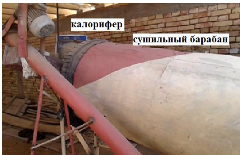
Рисунок 1. Опытный образец изготовленного устройства для сушки зерна.
