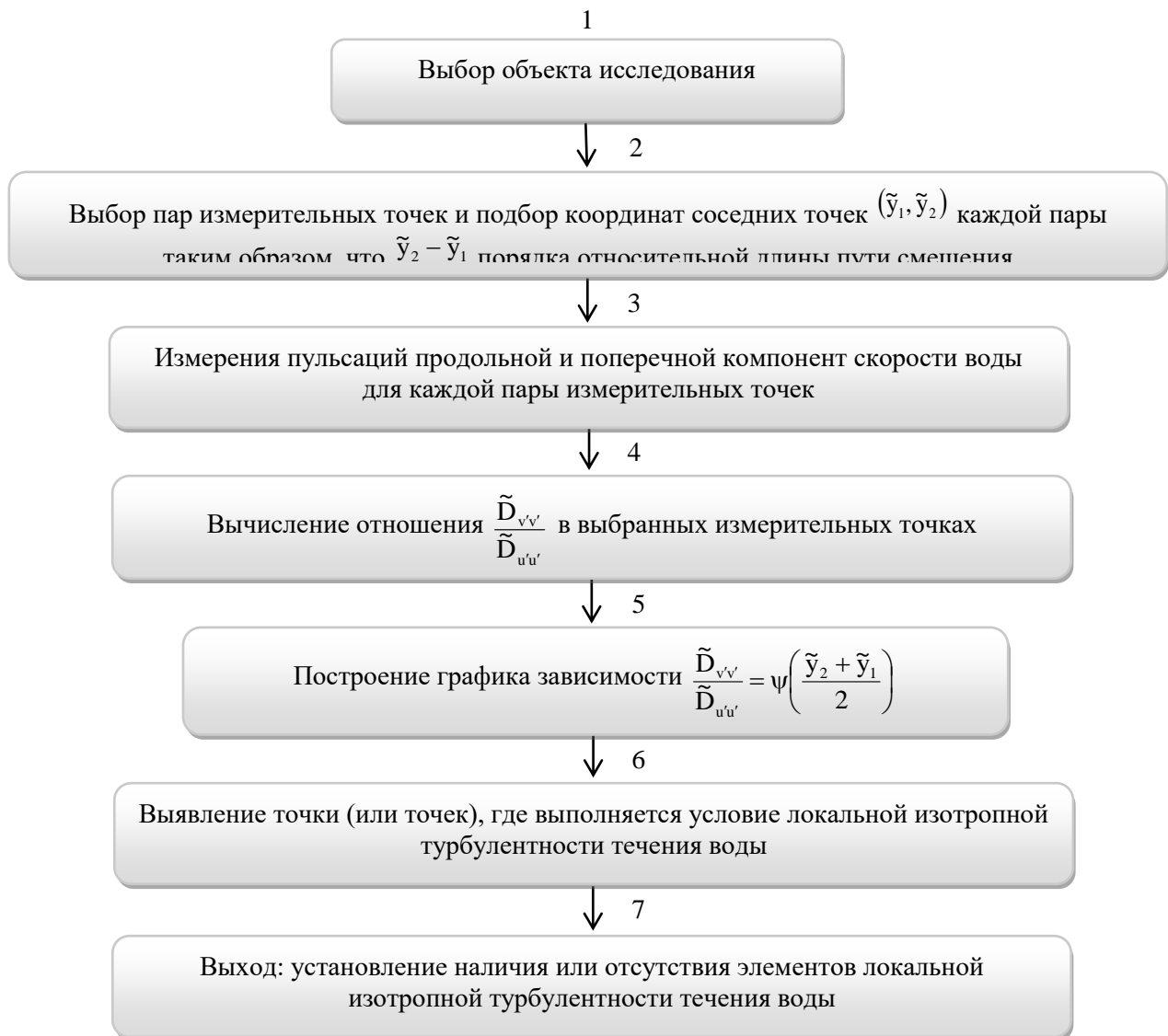
Рисунок 3. Структурная блок–схема метода выявления элементов локально изотропного течения в турбулентном потоке воды.
