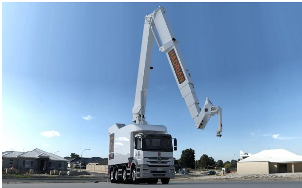
Рисунок 1. Изображение установленного оборудования Hadrian X на автомобильное шасси грузовика ( https://www.designingbuildings.co.uk/wiki/Hadrian_X ).
