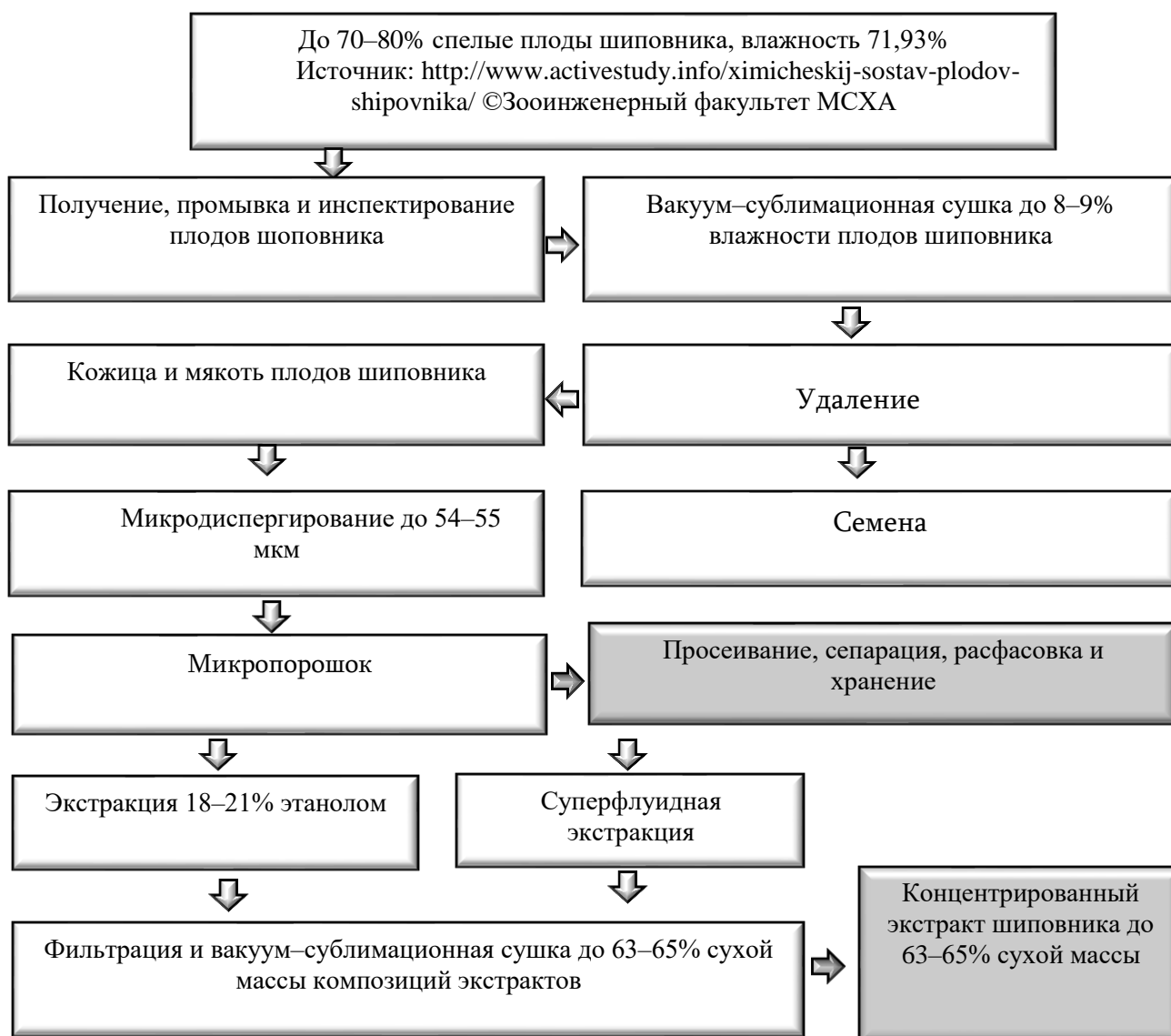
Рисунок 1. Технологическая схема получения микропорошка и концентрата из кожуры и мякоти шиповника.
