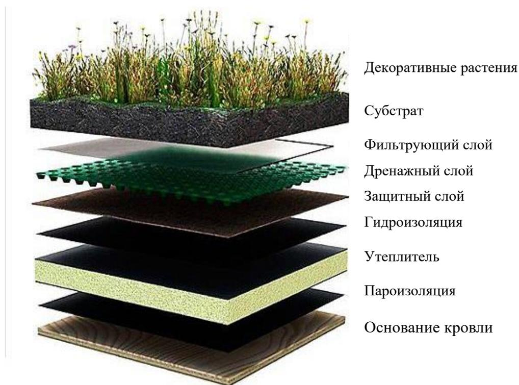
Рисунок 1. Строение «зеленой крыши».
