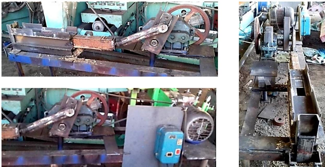
Рисунок. Лабораторная установка по уплотнению половы.
