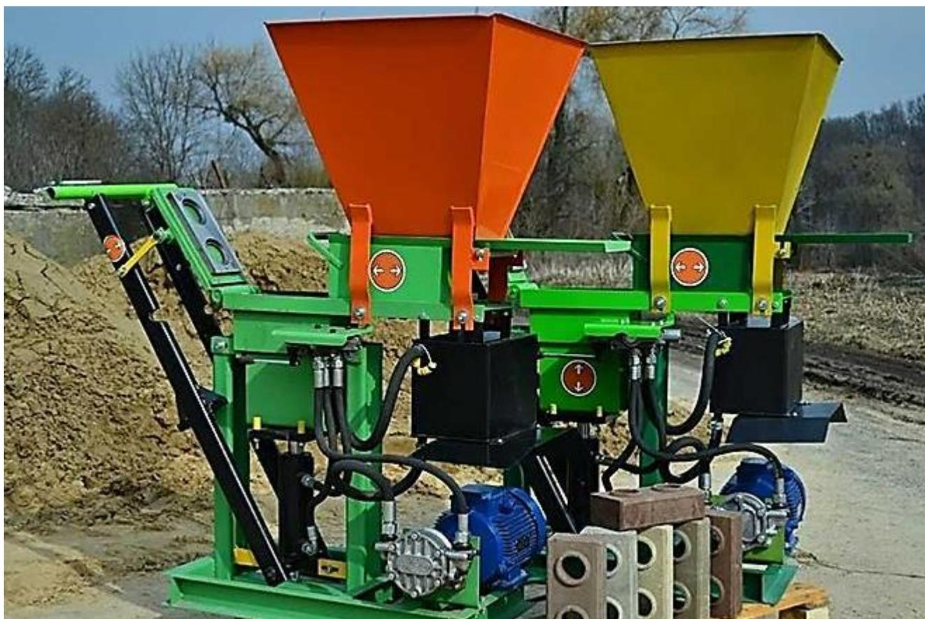
Рисунок 2. Пример станка для производства лево–кирпича.
