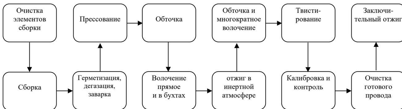
Рисунок 3. Технологическая схема производства многожильных NbTi сверхпроводников.
