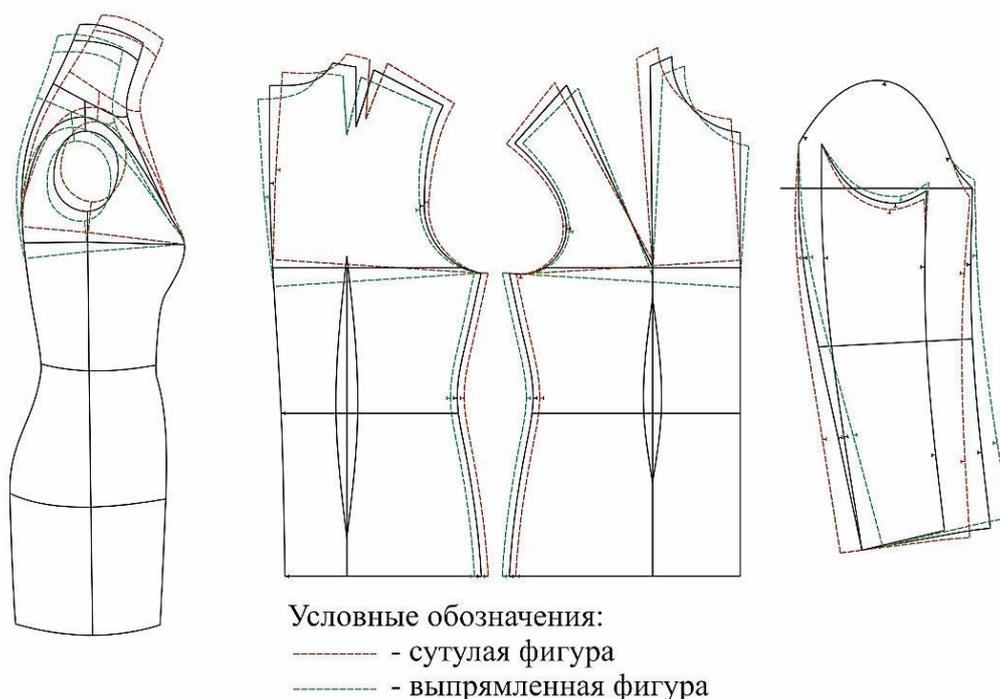
Рисунок 2. Взаимосвязь конструкции изделия от положения корпуса.
