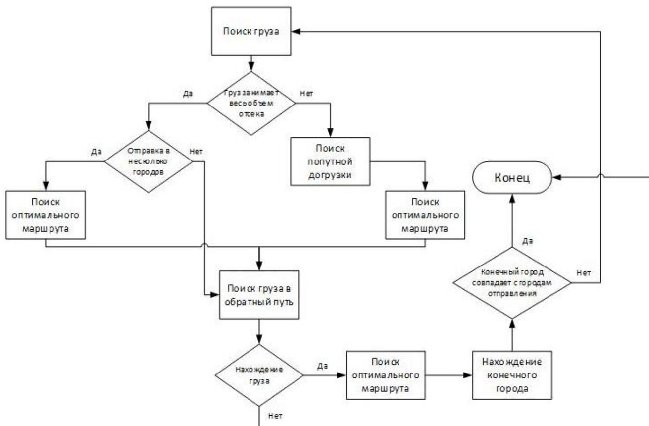
Рисунок 2. Алгоритм решения задачи развозки груза.
