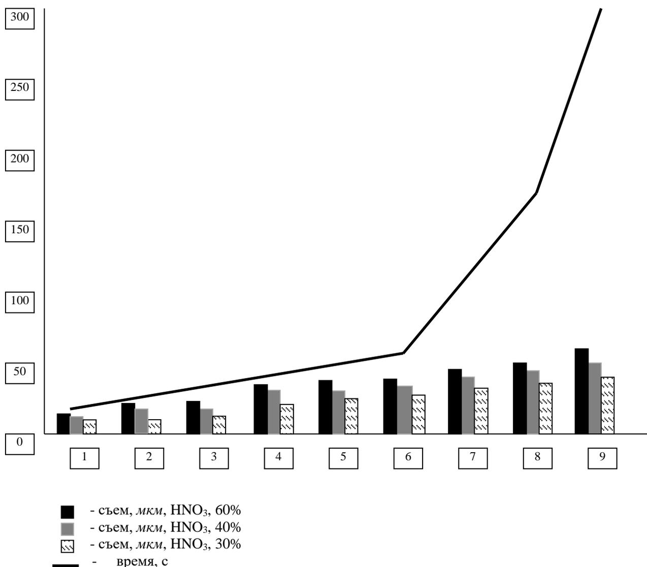
Рисунок 5. Диаграмма зависимости съема бронзового прутка от времени травления и концентрации азотной кислоты.
