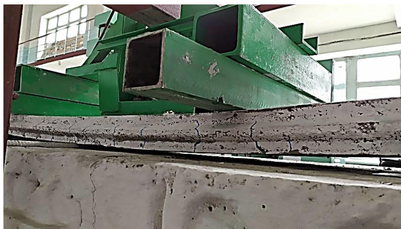
Рисунок 3. Испытание на разрушение испытуемого изделия
