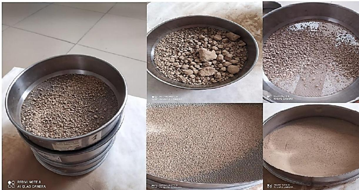
Рисунок 2. Пропускание суглинка через сито
