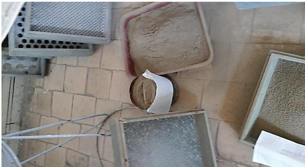
Рисунок 3. Пропускание через сито базальтового порошка
