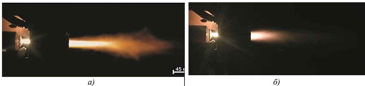
Рисунок 1. Фотография плазменного потока при: а) Q_{вх}=0.2 л/с; б) Q_{вх}=0.8 л/с;
