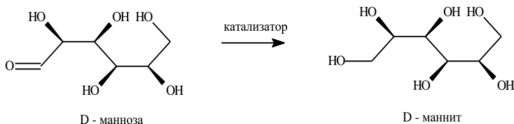
Рисунок 1. Схема каталитического получения D-маннита из D-маннозы
