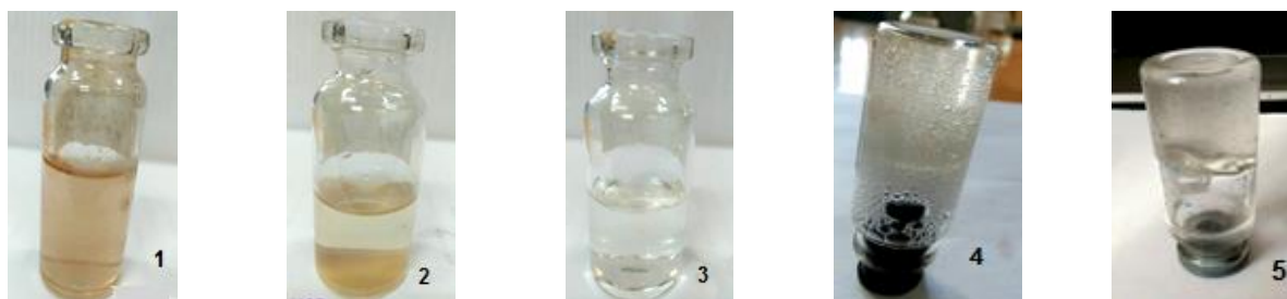
Рисунок 1. 1 — Цистеин-серебряный раствор. 2 — Созревший цистеин-серебряный раствор (ЦСР). 3 — Водный раствор глицирама (концентрация 10^{-3} М). 4 — Гидрогель после смешения ЦСР и раствора глицирама. 5 — Гидрогель после смешения GCP и раствора глицирама
