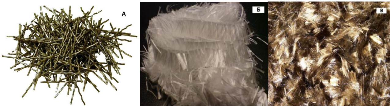
Рисунок. Армирующая фибра: А — стальная; Б — полипропиленовая; В — базальтовая
