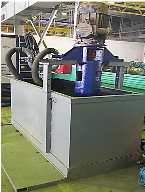
Рисунок 1. Стенд испытания шламовых насосов.
