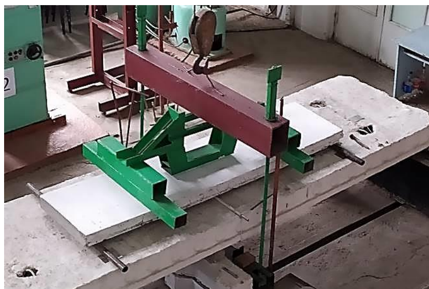
Рисунок 3. Схема расположения изделий при статических испытаниях
